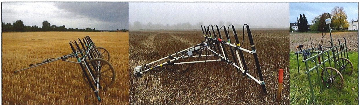
Foto: Mehrkanalige Fluxgate-Magnetometer mit Sonden der Fa. Sensys auf der zu untersuchenden Fläche
